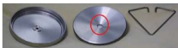
شکل ۲- الف. با سی ایکس-۵۷۲ ذرات به طور مستقیم بر روی نگهدارنده وزن می‌کنند.
