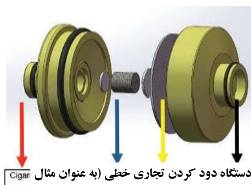
شکل ج- ب. با کارتریج بارگذاری شده سی ایکس-۵۷۲ که روی نگهدارنده قرار داده شده است.
