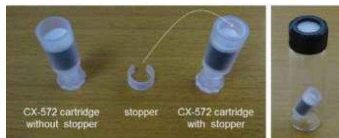
شکل ۶. درپوش هایی که باید در کارتریج های سی ایکس-۵۷۲ قرار داده شوند تا از مکیده شدن محتویات به داخل دستگاه سیگار جلوگیری شود.
