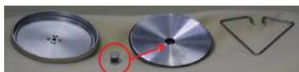
شکل ج- ب. با کارتریج بارگذاری شده سی ایکس-۵۷۲ که روی نگهدارنده قرار داده شده است.
