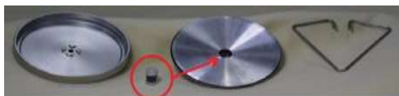
شکل ۲-ب. با کارتریج بارگذاری شده ۵۷۲-سی ایکس که روی نگهدارنده قرار داده شده است
